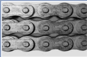
Neptune Test de jet d'eau saline de 700 heures
